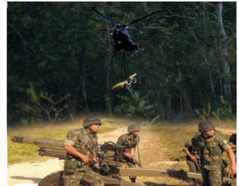
Imagem 01: Obus 105 mm auto rebocado, sendo helitransportado.
